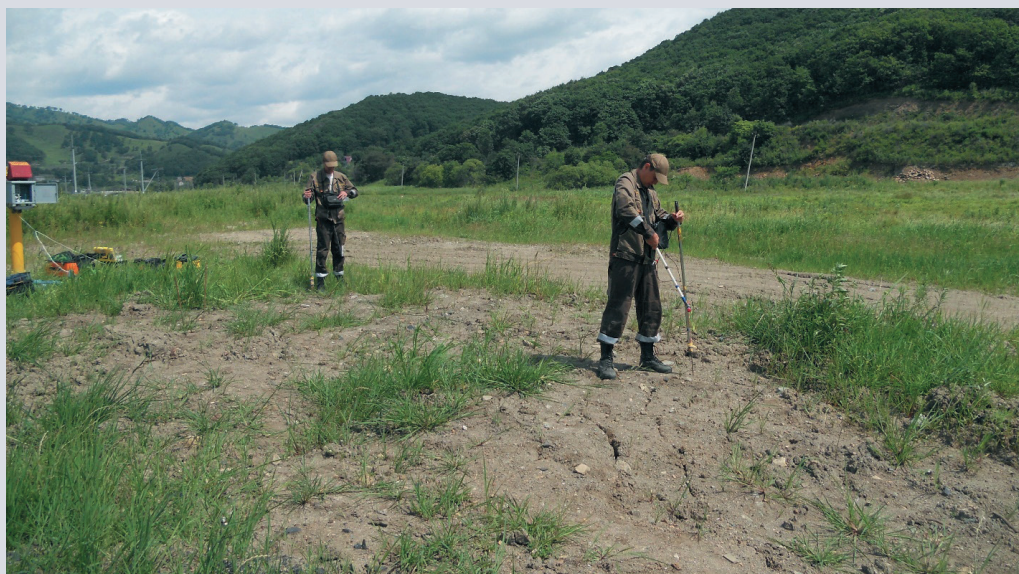
Рис. 4 Поиск места повреждения ПАЗ при помо- щи приборного комплекса ИП «Азимут»
